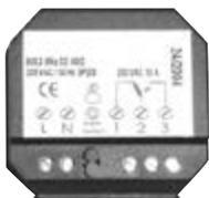
Ricevitore (48 x 51 x 28 mm) radio frequenza on/off (controllato da un termostato a radio frequenza) a installazione nascosta. Il ricevitore riceve gli ordini radio emessi dal termostato ambiente. Ricezione degli ordini e delle informazioni senza fili grazie alle onde radio. E' un ricevitore per radiatori o scaldasalviette.
